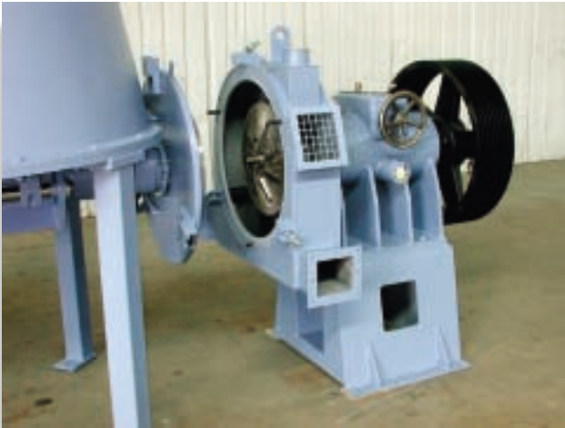
Im geöffneten Kompaktor sind die Kompaktorscheiben zu erkennen.
