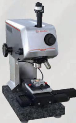
Scratch-Tester für Laboranalysen
