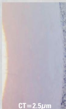
Der Anteil harter Komponenten (z.B. kubisches AlN) wird bei **Gradientstruktur** kontinuierlich erhöht, um die höchste Härte an der Oberfläche der Schicht zu erreichen.
