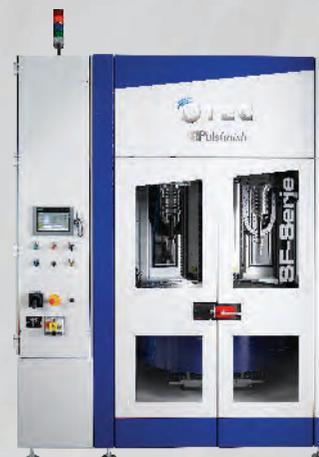
Die SF-Gleitschleif-Technologie führt Entgraten, Verrunden und Polieren in einem Schritt durch. Sie kann optional mit Pulspolieren erweitert werden. Dabei wird die Drehrichtung des Werkstückes periodisch geändert. In Abhängigkeit vom Anforderungsprofil kann die Maschine optional mit automatischen Beladungseinheiten versehen werden. Die typischen Anwendungsgebiete der Maschine liegen beim Polieren von Maschinenbauteilen, Gewindebohrern, Formwerkzeugen und Einspritzmodulen.
