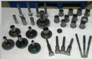
Beschichtete Werkzeuge zum Fließpressen von Aluminiumbauteilen
