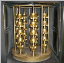
Beschichten von Fräserkopfhalterungen mit CrTiN & goldener Top-Farbe durch die  $\pi 303$  Konfiguration.
