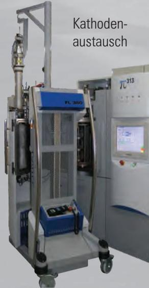
Gabelstapler für einfachen Transport geladener Karusselle und Kathoden zu und von der Beschichtungsanlage. Kompatibel mit den Maschinen der  $\pi$  Serie.
