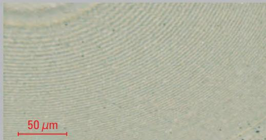
Schichtdicke = 4 µm
