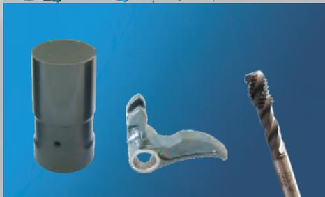
Duplexschicht mit nanogradienter Struktur
