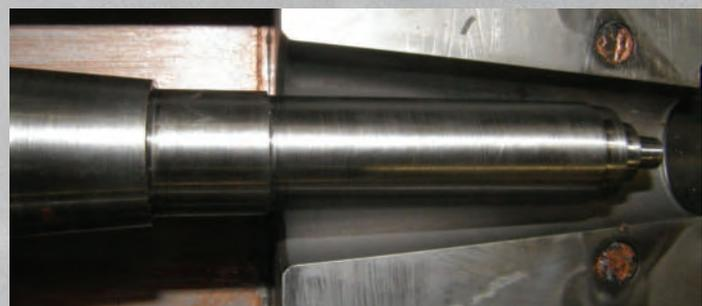
Werkzeug beschichtet mit ALLWIN, Cr-Al-Si basierte Schicht
