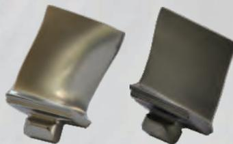
Blanke und beschichtete Turbinenschaufel mit Fi-Vlc<sup>®</sup>
