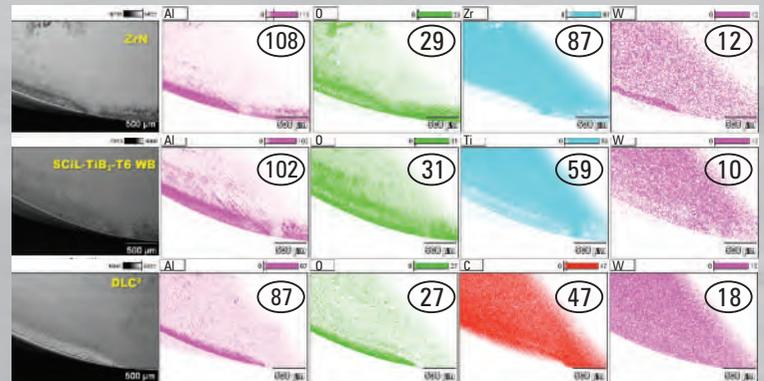
(X) EDX - Häufigkeit der einzelnen Elemente:  $DLC^3$  beschichtet mit  $\pi C_{211}$
