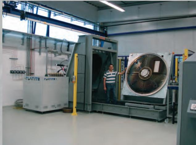
Sägebandspulen mit  $\varnothing$  bis zu 1.4 m beschichtbar. Die Rückseite des Sägebandes wird mithilfe einer Planarkathode beschichtet.
