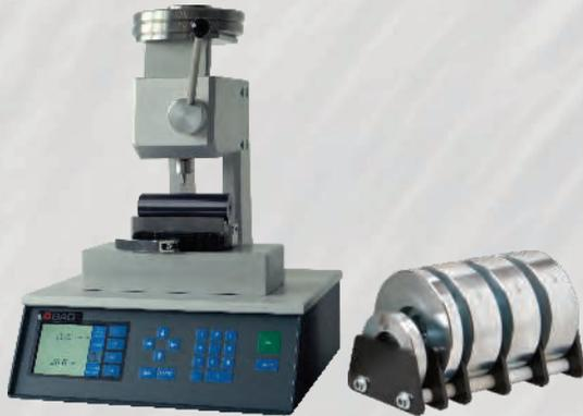
Scratch-Tester mit konstanten Lasten zum Testen in der Produktion (go or no go)
