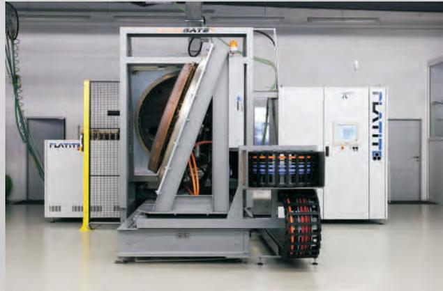
Sägebänder bis zu 200 mm Höhe beschichtbar. Der Werkzeugträger ist geeignet um eine konstante Schichtdickenverteilung zu erreichen.
