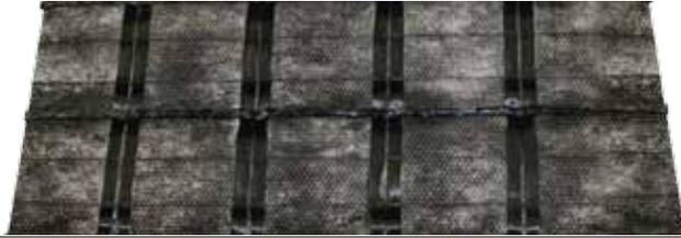
Asphaltgrid Comp ist eine Asphaltarmierung zusammengesetzt aus einem Geogitter aus Polyester und einen Vliesstoff aus Polypropylen. Diese Armierung ist mit einer Beschichtung aus EVA (Ethylvinylacetat) versehen um wärme- und alterungsbeständig zu sein.
