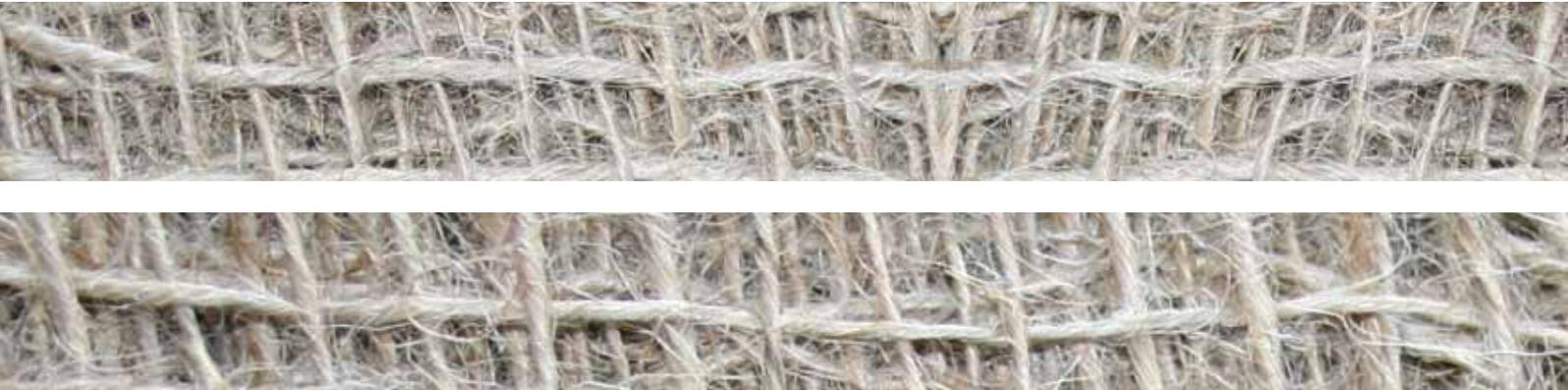
Offenmaschiges Biogewebe bestehend aus Jute mit Flächengewichten von 125 - 500 g/m<sup>2</sup>. Dienen als Erosionsschutz und gleichen zudem Temperaturschwankungen aus, was die Keimung des Saatgutes günstig beeinflusst. Da Wasser sehr gut gespeichert und auch nur langsam wieder abgegeben wird, kann zusätzlich der Austrocknung des Bodens entgegengewirkt werden.
