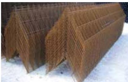
Stahlkörper aus Baustahlmatten
