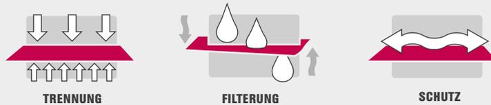
T - Geodren PPEXT wird als Trennlage im Erdreich zwischen verschiedenen Materialien oder Korngrößen verwendet.
