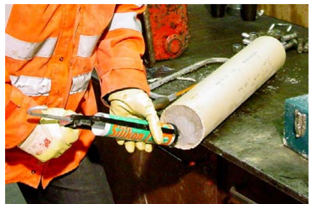
Abbildung 9: Setzen einer Silikonplombe unmittelbar nach Probenauswahl bei einem veränderlich festen Mergelstein, der mittels Mehrfachkernrohr und Kunststoff-Inliner gewonnen wurde.
