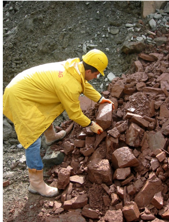
Abbildung 13: Entnahme frischer Tonschieferproben von Zwischendeponie bei einem Sprengvortrieb.
