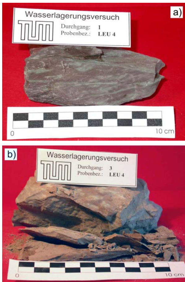
Abbildung 6: Beispiel für einen Trocknungs-Befeuchtungs-Versuch an einem Mergelstein. Bei einmaliger Wasserlagerung (a) zeigt das Gestein keine Reaktion, zerbricht jedoch nach 2-maliger Trocknung und Wiederbefeuchtung in Einzelaggregate (b), aus: [12].
