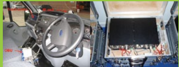
Bordbestandteile und Nahaufnahme von CVIS On-Board-Unit (ein PC), bei einem CVIS-Versuch in London in Verwendung. Quelle: Transport for London
