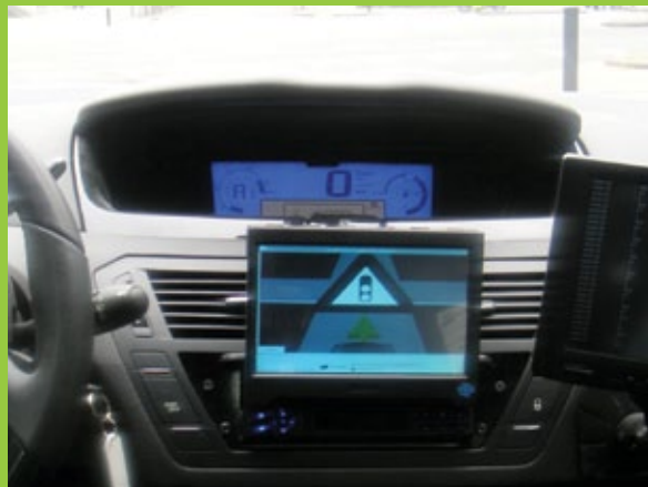
Beispiel eines mit CVIS ausgestatteten Fahrzeuges (Bestandteil innerhalb des Fahrzeuges). Quelle: Peek Traffic
