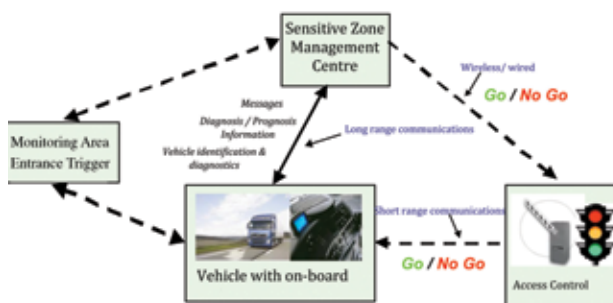
Anwendung zur Zugangskontrolle Quelle: Volvo Technology Corporation
