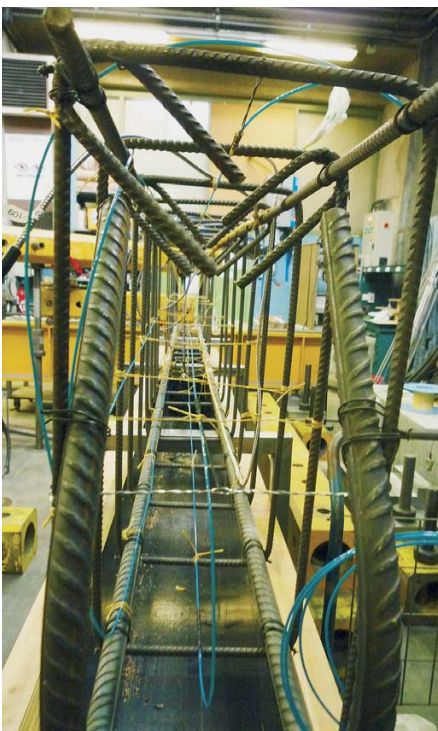
Bild 6: Stahlbetonbalken mit Glasfaserkabel (blau) vor dem Ausgießen mit Beton. Das Kabel verläuft als Schleife im oberen und unteren Segment, um Zug und Druckspannungen zu erfassen (Bild: [1])
