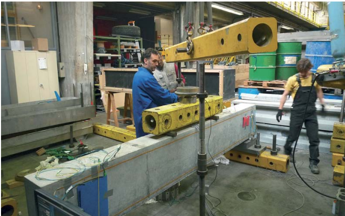
Bild 5: Belastungstest an einem Stahlbetonbalken, in den ein faseroptisches Kabel zur Messung der Dehnung über Rayleigh-Streuung integriert ist (Bild: [1])
