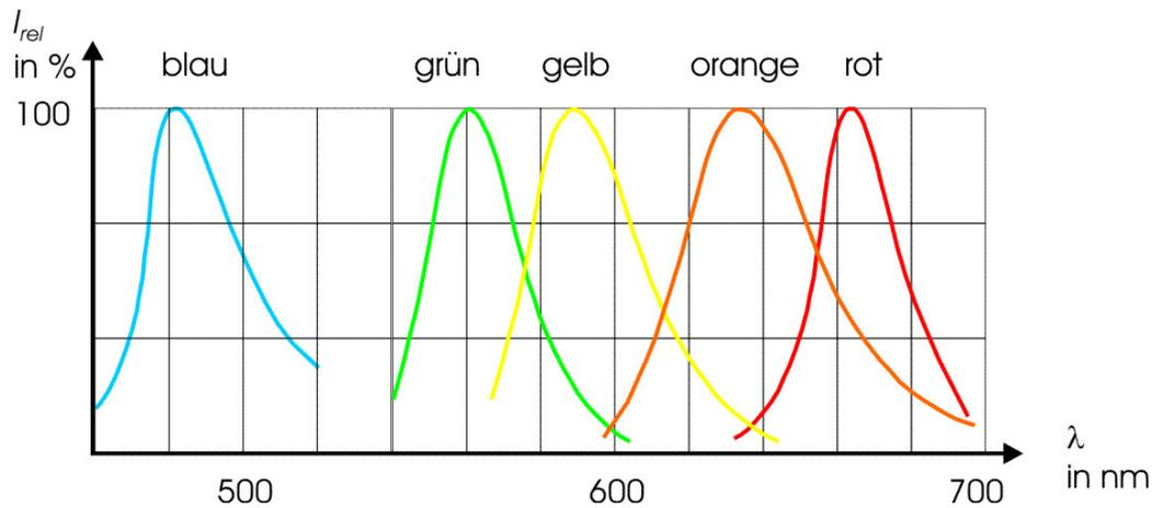
Abbildung 11: Die spektrale Verteilung der Leuchtdioden im Praktikum. Die Wellenlänge der emittierten Strahlung ist abhängig vom Halbleitermaterial und dessen Dotierung.
