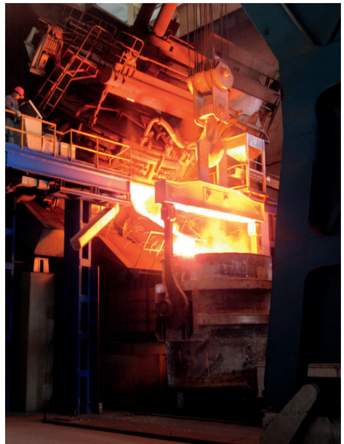
Abstich des Elektrolichtbogenofens, in dem 30 bis 80 t Stahl pro Charge geschmolzen werden können.
