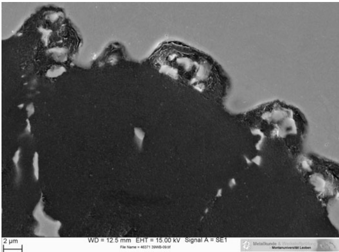
Abb. 16: REM-Aufnahme einer Graphitkugel mit diskontinuierlichem Saum aus Mikrohohlräumen, Graphit und Eisen: Detail aus Abb. 15.
