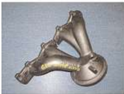
Bild 32: Innovationen Werkstoffentwicklung: GJS-SiMo1000 für Auslasskrümmer.
