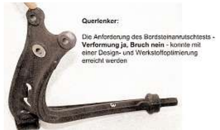
Bild 30: Innovationen Werkstoffentwicklung: Hochverformbarer Sibodur®-440-17
