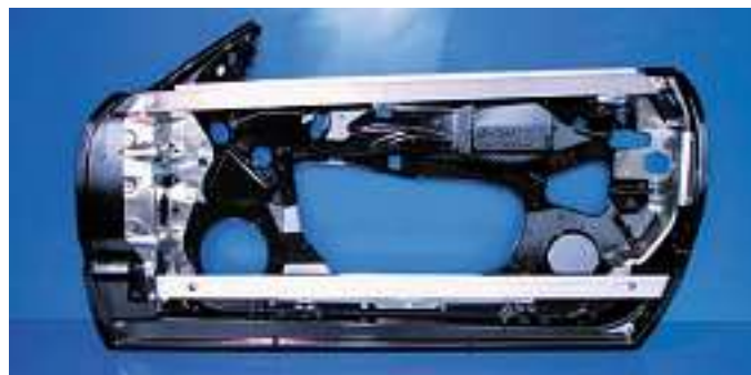
Bild 11: Innentüre mit Anbauteilen
