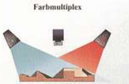
Bild 15: Innovationen Prozesstechnik: Digitale Überprüfung von Kernen (Patent Hottinger)
