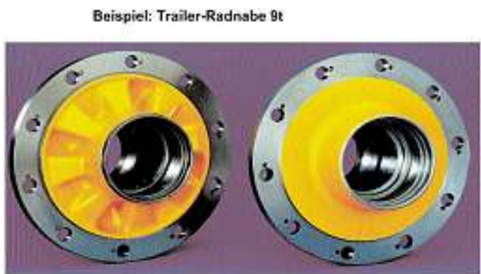
Bild 22: Innovationen Designentwicklung: Substitution von Stahl durch Guss
