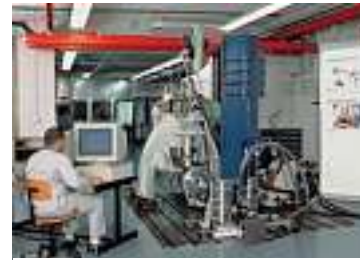
Mehrkanalprüfstand (bis 3K) zur Prüfung von Bauteilen mit Echtzeitsignalen und unter Korrosionseinfluss
