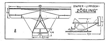
Aussehen und Abmessungen gehen aus der Zeichnung hervor. Diese Maschine ist leichter als der R. R. G.-"Zögling" gebaut und wiegt rund 70 kg. Tragflächen-Inhalt ca. 15 m². An Stelle des hölzernen "Gitterschwanzes" beim R. R. G.-"Zögling" werden hier als Träger des Leitwerkes vier Stahlrohre verwendet, die einen großen Teil zur Dauerhaftigkeit der Maschine beitragen. Die übrigen Bauteile sind ähnlich wie beim R. R. G.-"Zögling".
