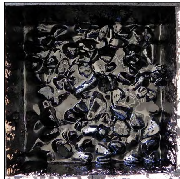
zu hoher Bitumenspiegel bei zu hohem Bitumenanteil im Mischgut
