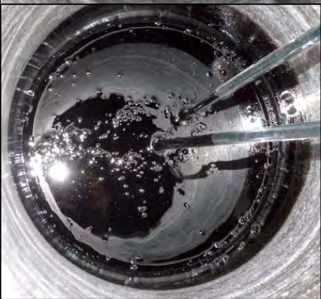
Hartes Bitumen 180 °C
