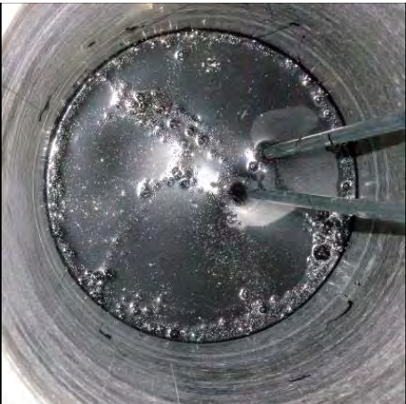
Hartes Bitumen 180 °C
