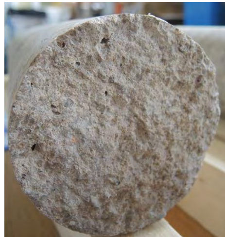
Betonierabschnittsgrenze unmittelbar neben Bruchfläche 0,94 m – 1,00 m
