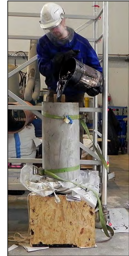
optimaler Bitumenspiegel bei optimalem Bitumenanteil im Mischgut
