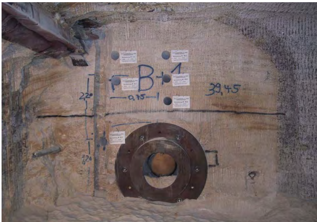
Abb. 44 TSS-Versuchsfeld: Probenahmestellen im kompaktierten Versatz
