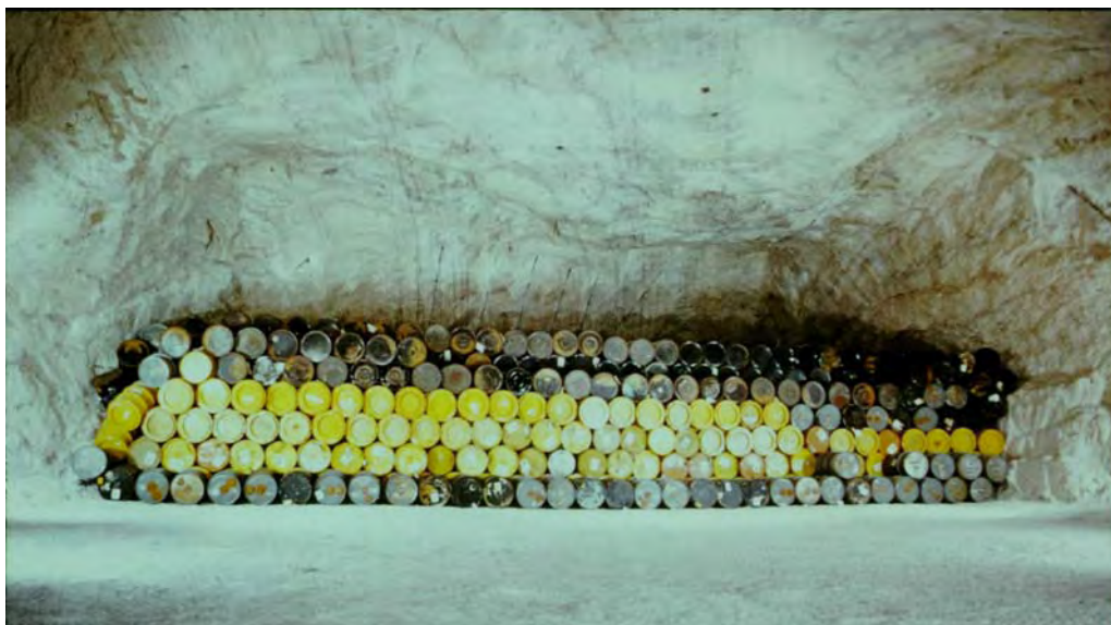
Abb. 32 Versuchseinlagerung von schwachradioaktiven Abfällen - liegende Stapeltechnik auf der 750-m-Sohle (Quelle: GSF)
