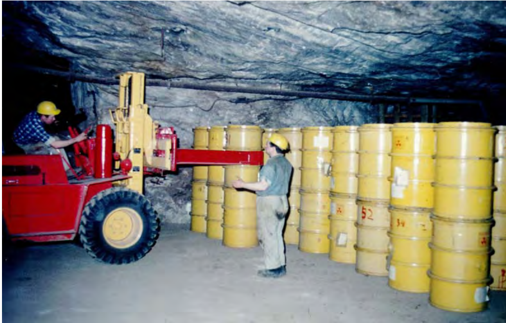
Abb. 31 Versuchseinlagerung von schwachradioaktiven Abfällen - senkrechte Stapeltechnik auf der 750-m-Sohle (Quelle: GSF)
