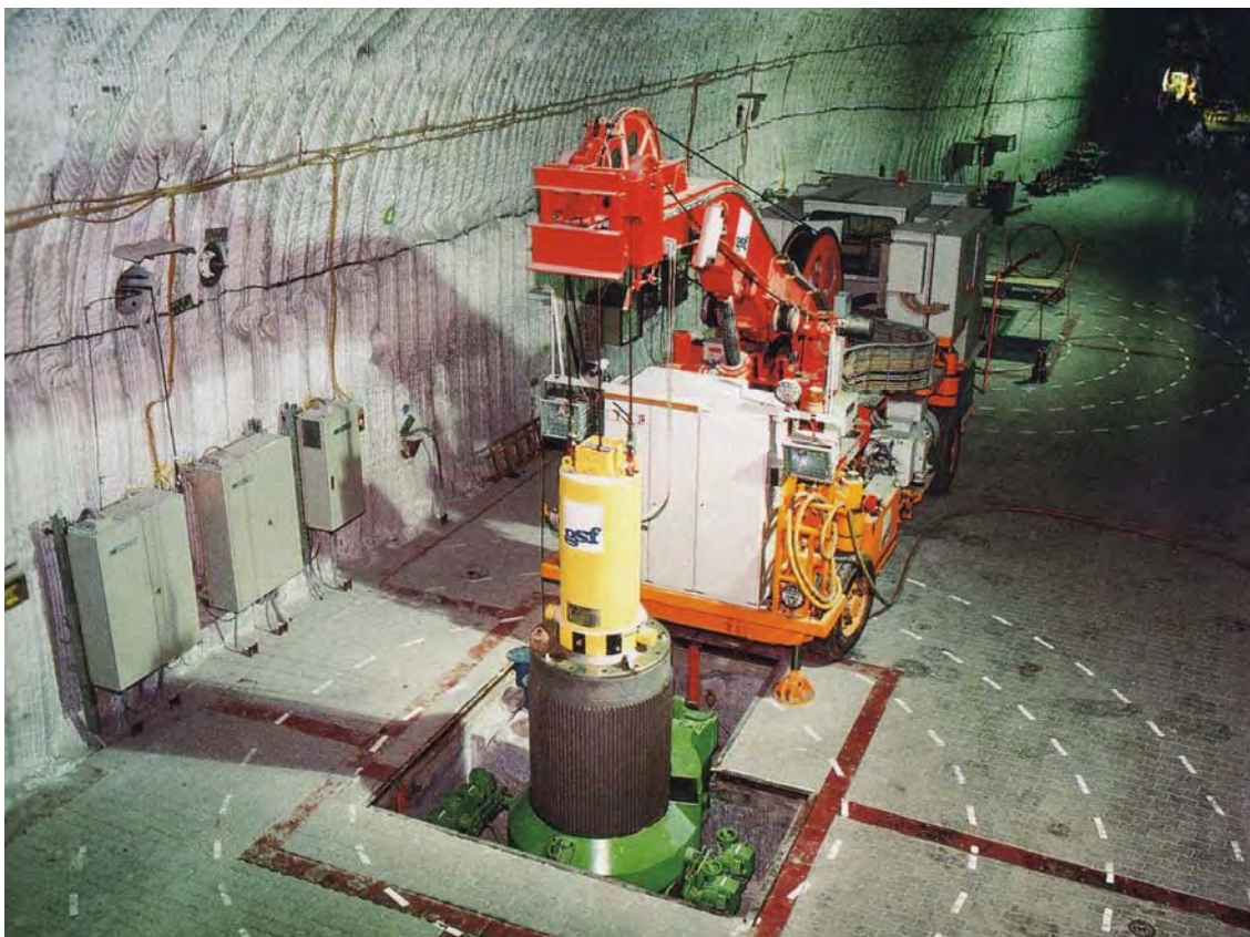
Abb. 40 HAW-Versuch zur Demonstrationseinlagerung hochradioaktiver Versuchsquellen: Einlagerungsmaschine am Einlagerungsbohrloch /GSF 95/
