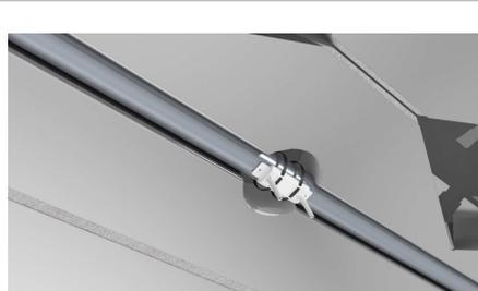
Alternativ kann für das Setzen der Feuchtfühler und/oder Pressverbinder auch eine Lochsäge mit min. 60 mm Durchmesser verwendet werden. Hier kann die Öffnung auch noch erstellt werden, wenn das Modul bereits hängt.
