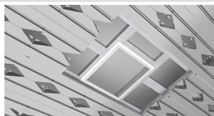
Die Module werden so ausgeschnitten, dass Deckeneinbauten ordentlich umfahren werden können.
