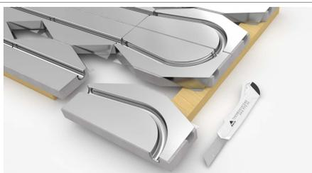
Damit der Systemrohr mit dem Zuleitungsrohr ordentlich verbunden werden kann, muss der äußerste Halbbogen ausgeschnitten werden.
