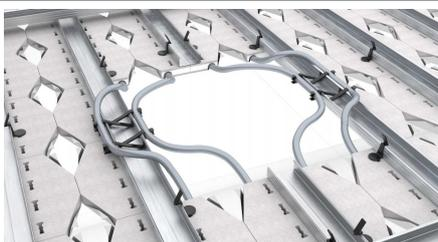
Es können pro CD-Profil maximal 2 Systemrohre verzogen werden. Dazu werden diese versetzt auf beiden Seiten eingelegt.
