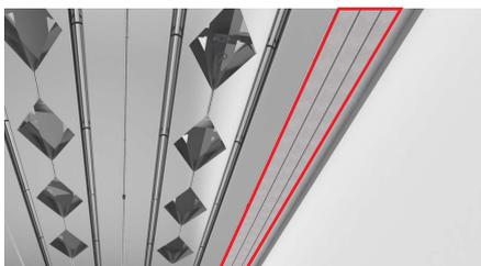
Nicht belegte CD-Profile müssen mit dem Ausgleich beklebt werden. Der Bereich zwischen den CD-Profilen bleibt frei. Bei Ausführung einer Schattenfugen darf der Ausgleich (rot umrandet) nicht bis zur Wand ausgeführt werden, da dieser sonst sichtbar bleibt.
