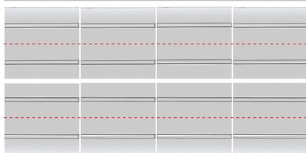
Die Module sind so flexibel aufgebaut, dass sie in 8 Einzelteile zerlegt werden können. So können die Module ohne viel Aufwand auf die örtlichen Gegebenheiten zugeschnitten werden.
