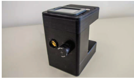
Abb. 1: Komplettsystem DF-01. Vorn die Detektoren für H'(0,07) links und für H^*(10) rechts.
