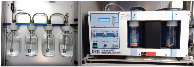
Abb. 3: Die PSI Tritiumsammelstelle wurde gegen den MARC 5000 von SDEC ausgetauscht.
