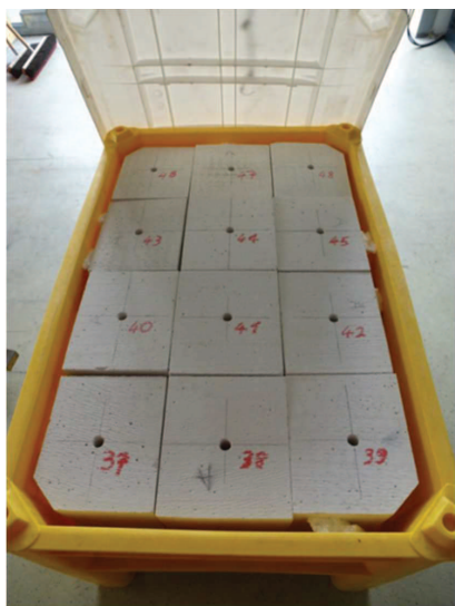
Abb. 1: Vergleichsgebinde mit Porenbetonquadern
