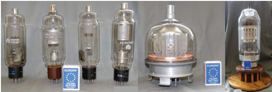
Abb. 1: Exemplare der untersuchten Röhren von links nach rechts: Verschiedene Exemplare der Diode Typ 8020 und CV 2967 (links), Schaltetetrode GMI-7 (Mitte), Thyatron TGI-1-700/25 (rechts)
