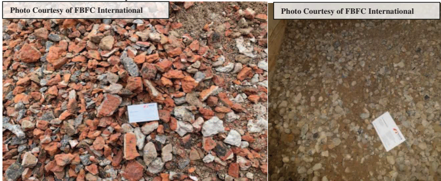
Abb. 6: Steine und Beton, zerkleinert auf unter 2,5 cm Korngröße als Beispiel für neue Materialtypen, die mit dem System verarbeitet werden können.
