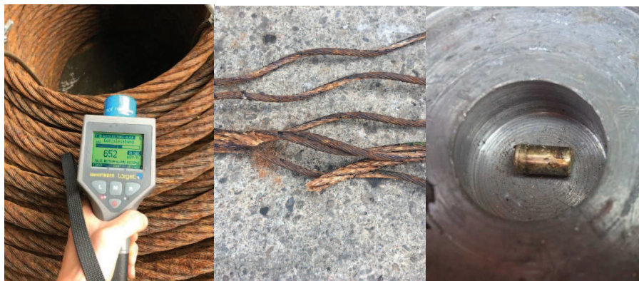
Abb. 2: Seil, Seilstück nach Entfernung der Quelle, Quelle im Bleibehälter
