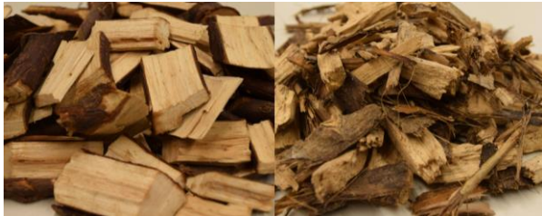
Bild 4.4 Unterscheidung zwischen Hackschnitzeln (geschnitten mit scharfen Werkzeugen, links) und Schredderholz (zerkleinert mit stumpfen Werkzeugen, rechts).
