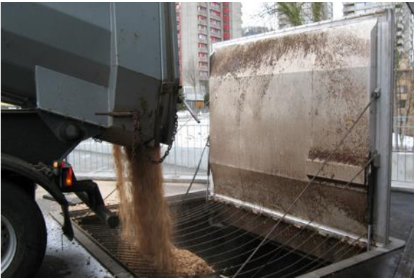
Bild 14.1 Beschickung Unterflursilo (Quelle Holzenergie Schweiz).
