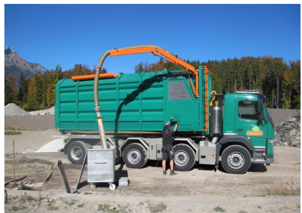
Bild 14.8 Transportfahrzeug mit aufgebautem Ascheabsaugsystem (Quelle: Holzenergie Schweiz).
