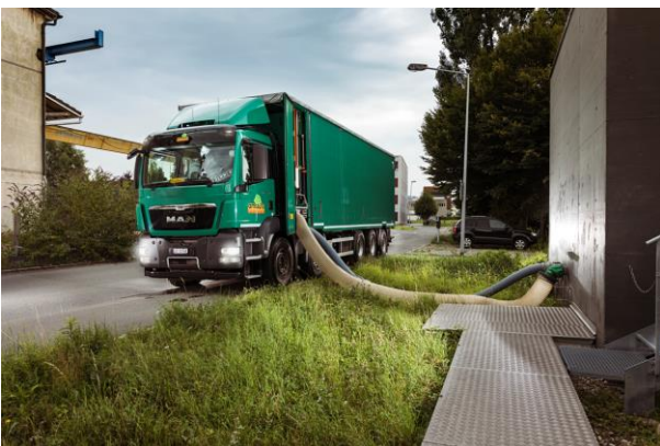
Bild 6.14 Pumpcontainer (Quelle: Amstutz Holzenergie AG).
