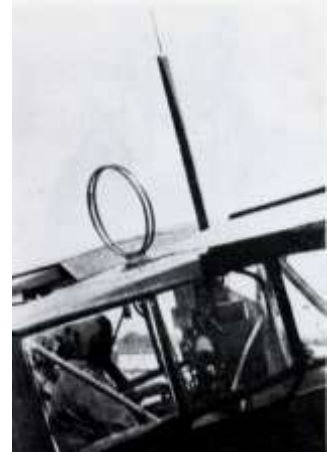
Empfänger R30 mit Zielflugvorsatz und festem Rahmen im „Storch“
