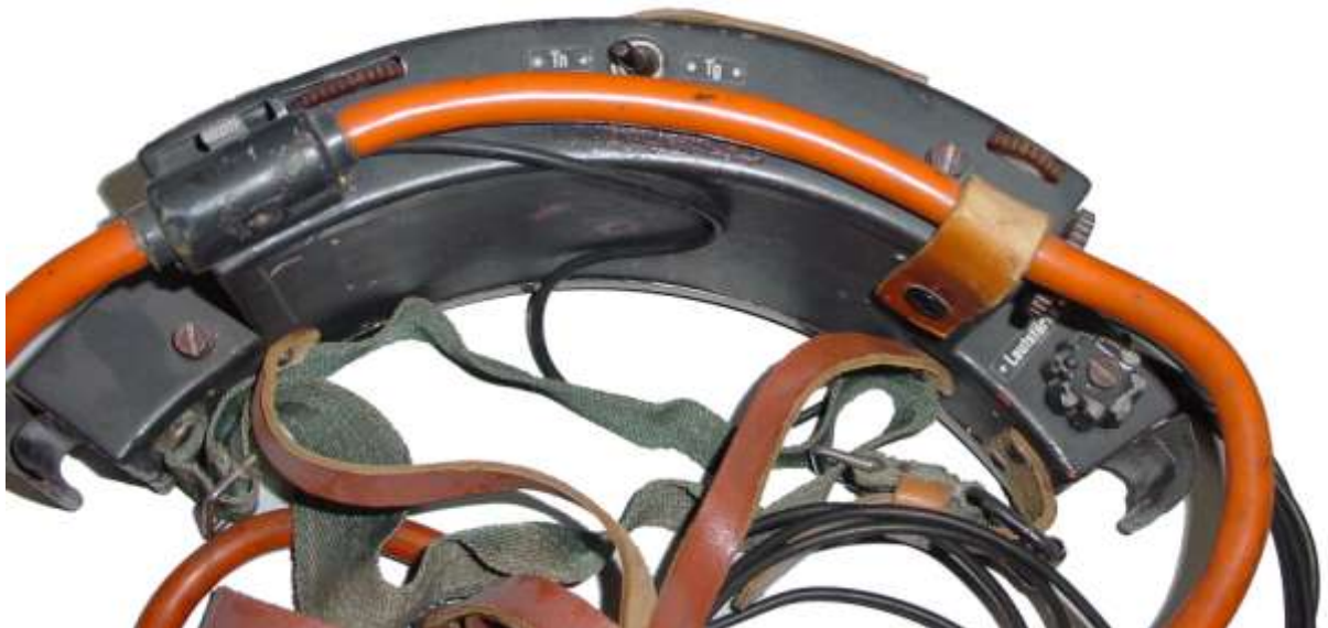
In der Draufsicht erkennt man den Umschalter Telephonie / Telegraphie (Mitte) den Schiebeschalter, mit welchem von Rahmen auf Antenne umgeschaltet werden kann (links), daneben das Abstimmrad für die Antennenabstimmung und die Frequenzeinstellung (rechts)
