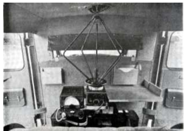
Inneres eines Peilwagens mit Kapsch-Peiler
