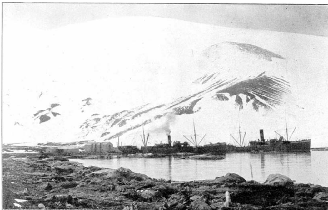
Abb. 137. D. „Hektoria“ und D. „Ronald“ der Walfang-Gesellschaft „Hektor“ in Tönsberg in der „Deception Bay“. South Shetland. Beide Dampfer sind mit Telefunkenstationen Type 1,5 TK (ca. 3 KW Primärenergie) ausgerüstet. D. »Hektoria« stand von hier aus in gegenseitiger Nachtverbindung mit der Station Fort Stanley auf Falkland, die Entfernung zwischen beiden Stationen betrug ca. 1300 km über ca. 500 m hohes Gebirge hinweg.
