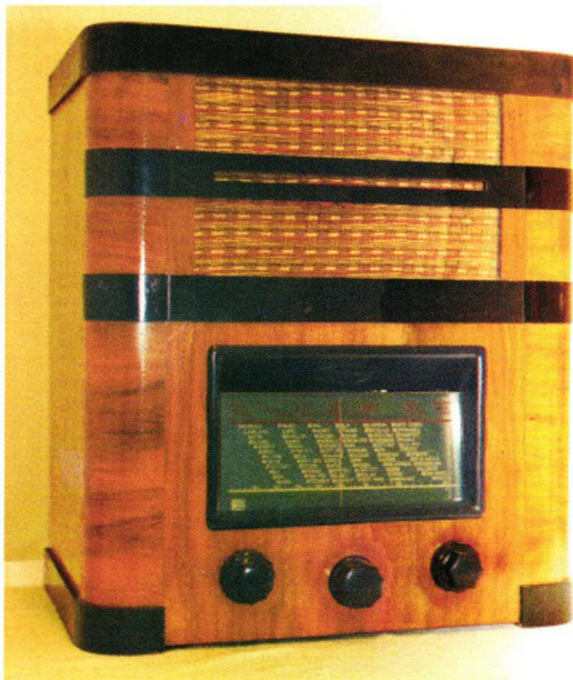
RADIONE AW 44, 7 Kreise, Baujahr 1935. Röhren: AF 7, AF 3, ABC 1, AL 1, RGN 1064
