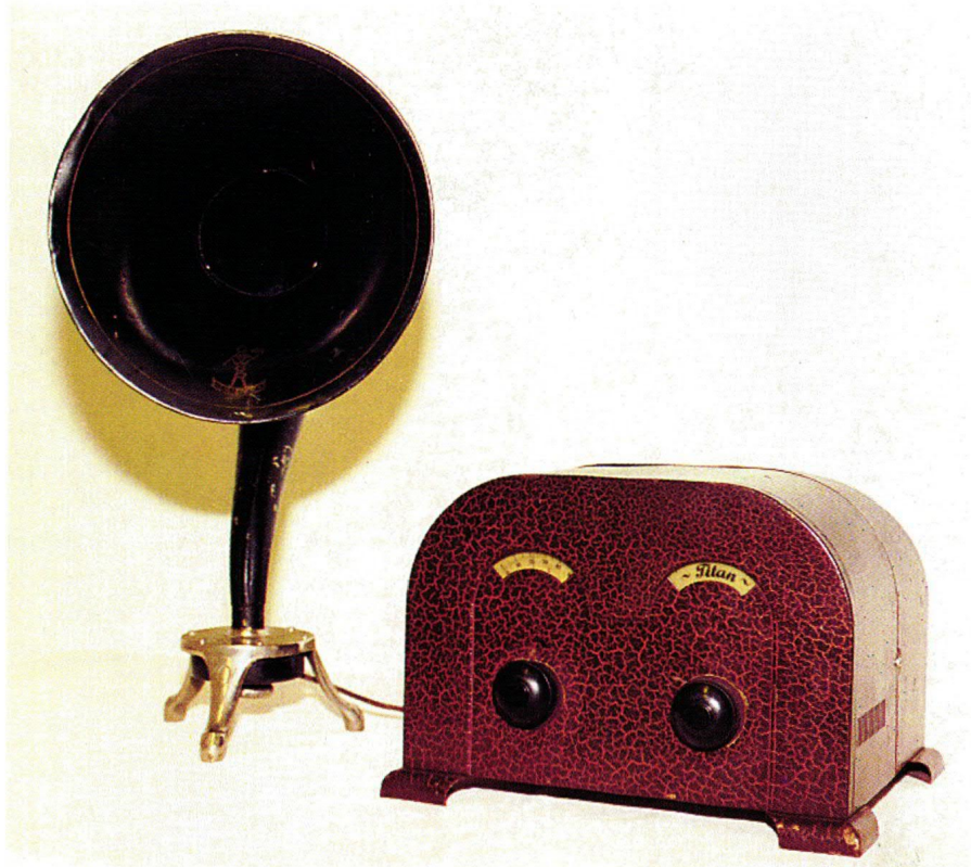
ÖTAG BERLINER "Titan BA", Einkreiser, Baujahr 1930. Röhren: E 424, E 438, C 443, 506
