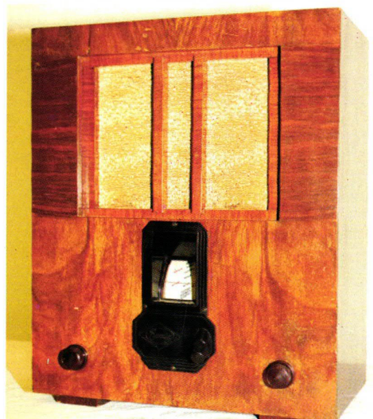
EUMIG 633, Einkreiser, Baujahr 1934. Röhren: B 2038, B 2038, B 2043 u.
