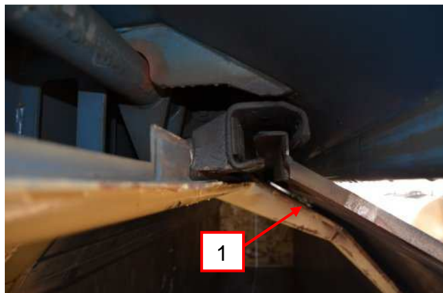
Bild 41: Dichtschlauch an Stirnwand
