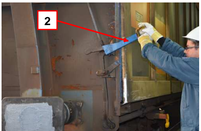
Bild 4: Öffnen der Schiebewand durch Verschwenken des Verschlusshebels
