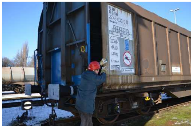
Bild 6: Verschieben der Schiebewand
