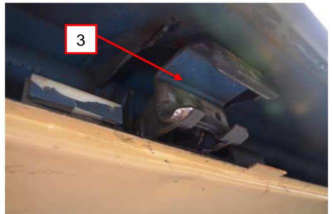
Bild 39: Klaue, zum Schließen der Schiebewand
