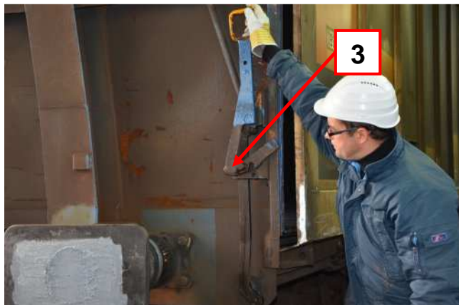
Bild 5: Einrasten der Sicherungsfalle
