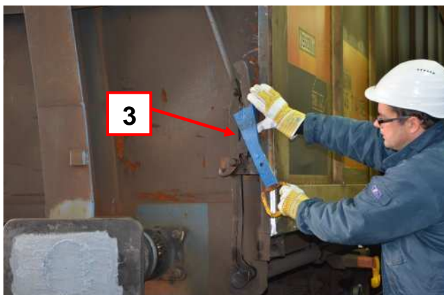
Bild 3: Entsicherung des Verschlusshebels
