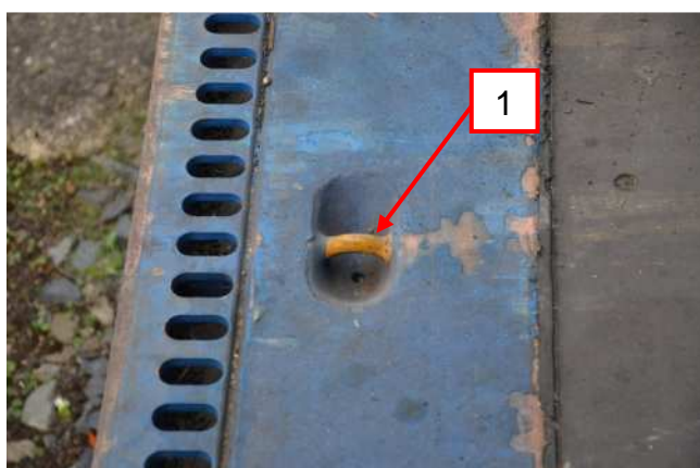
Bild 46: Verzurröse im Fußboden
