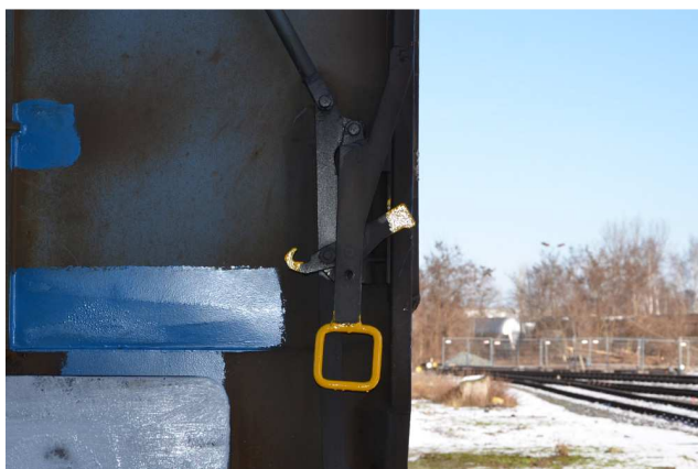
Bild 10: in Sicherungsfalle eingerasteter Verschlusshebel
