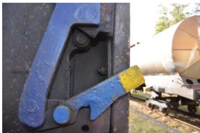
Bild 33: Verschraubung der Bedieneinheit
