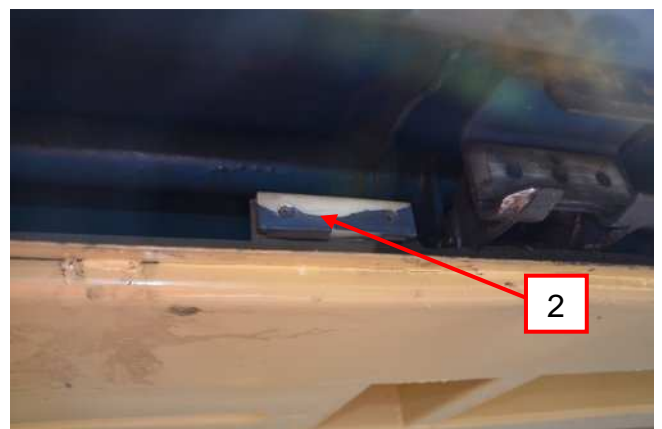
Bild 18: Wandanschlag am Dachträger
