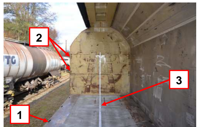
Bild 14: Verzurrösen in Stirnwand und Fußboden, Markierung der Wagenmitte
