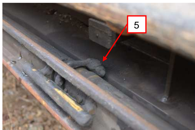
Bild 52: Lagerschalen der Laufschiene
