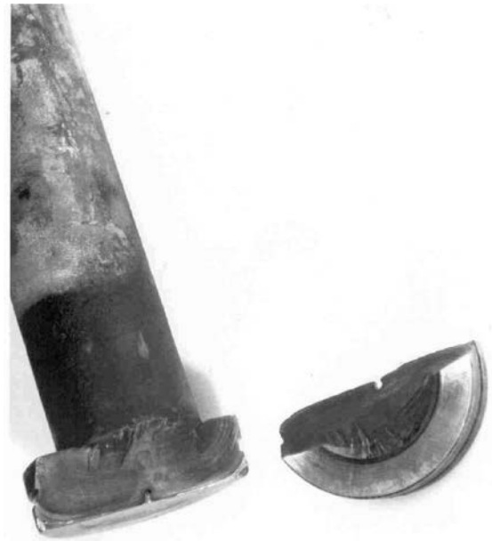
Bild 9: Bruchstelle am Einspannbund Stufenkolben 6. Stufe
