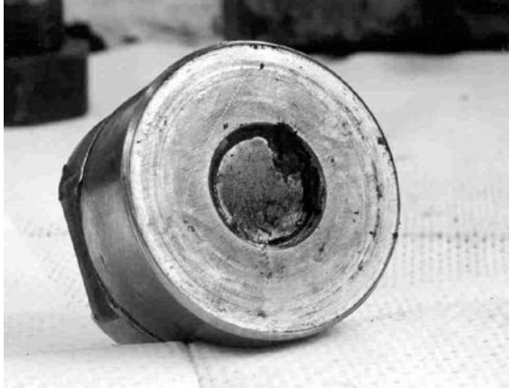
Bild 4: Abgerissene Kolbenmutter des Stufenkolbens 6. Stufe
