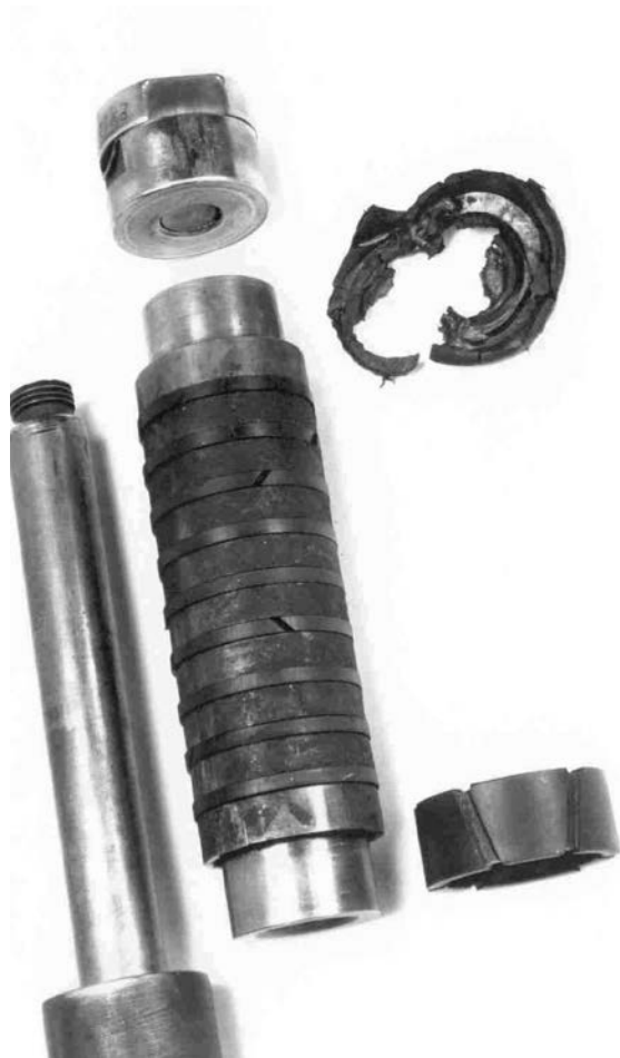
Bild 10: Bruchstelle im Befestigungsgewinde M 20 x 2 des Stufenkolbens 6. Stufe
