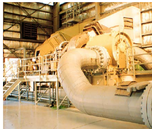
Abb. 5: Typische gasturbinen-getriebene Turboverdichtereinheit
