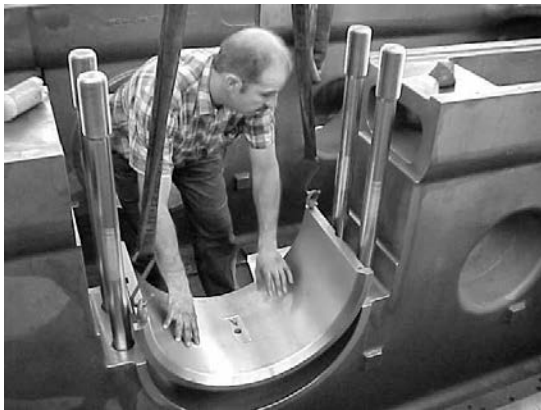
Bild 11 Einbau eines Fertiglagers
