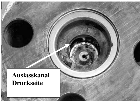
Bild 5 : Ansicht auf druckseitigen Auslasskanal Zylinderkopf 6. Stufe
