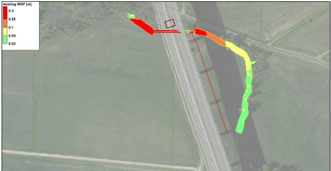
Abbildung 5-13: Anstiege der Wasserspiegellagen zwischen bauzeitlichen Zustand und Istzustand beim HQ_5
