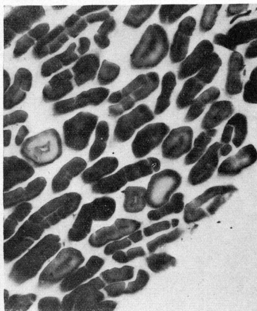
Abb. 29. Ramiefaserquerschnitte, während 44 Tagen gefärbt. Defekte Fasern ganz durchgefärbt, bei Fasern ohne Störungen ist erst die Randzone gefärbt. 200mal vergrössert.
