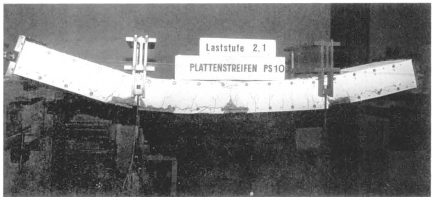
Bild 61: Gelenkausbildung und Verformung PS 10
