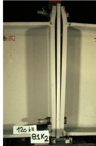
Abb. 5.40: Lokale Verformung der Kopfplatte bei der überstehenden Kopfplatte und daraus her- vorgehende zusätzliche Biegung der Schraube am Beispiel der Ausführung mit zwei Schrau- benreihen und schaftlosen Schrauben DIN 933 der FK 8.8 (Versuch 8.1K2)
