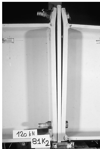
Abb. 1.03: Geschraubter Stirnplattenstoss: Typisches Verformungsbild beim Erreichen der Tragfähigkeit der Verbindung mit überstehender Kopfplatte
