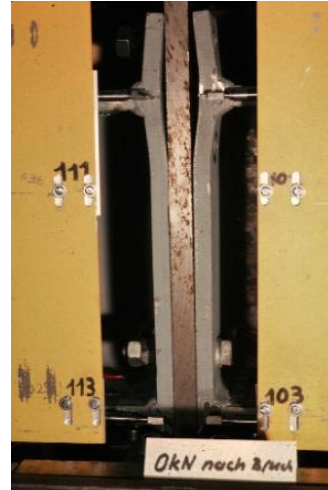
Abb. 5.37: Verformung der Stirnplatte bei der überstehenden Ausführung mit vier Schraubenreihen bei der Verbindungsausführung mit HV-Schrauben M16 der FK 12.9. Plastische Verformung des Überstandes sowie der Aussenbereiche der Platte innerhalb des Profils. Versuch 17D2
