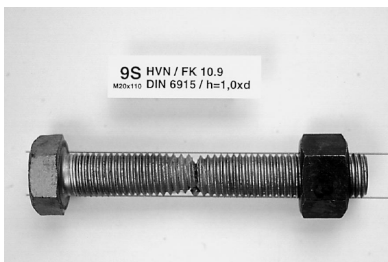
Abb. 3.48: Deutlich erkennbare Einschnürungszone bei der Schraube ohne Schaft, aufgezeigt am Beispiel der HVN-Schraube
