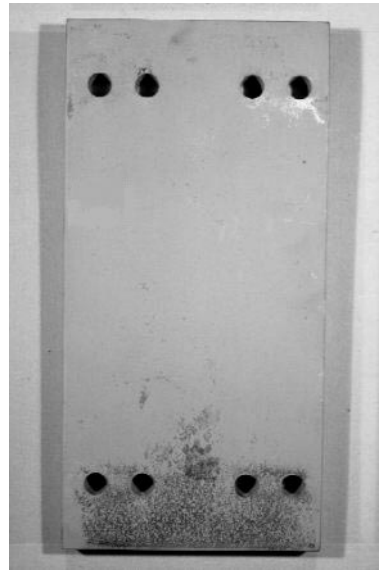
Abb. 5.14: Bei der bündigen Stirnplattenausführung mit vier Schraubenreihen sind im Versuch 8.2K1/IPE 500-8xM20 im Zugbereich keine Druckstellen festzustellen, welche auf zusätzliche Hebelkräfte hindeuten
