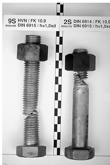
Abb. 3.49: Die neue HVN-Schraube im Vergleich zur gebräuchlichen HV-Schraube DIN 6914 am Beispiel der M20 x 110 (HVN-Schraube M20 x 160 auf Schraubenlänge 110 mm abgelängt)
