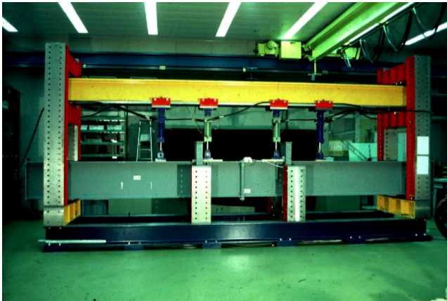
Abb. A.1.04: Gesamtansicht der Versuchsanordnung: Im Versuchsrahmen eingebauter Prüfkörper mit zu prüfender Verbindung in Spannweitenmitte, vier hydraulische Zylinder zur Lastaufbringung und Kipphalterungen
