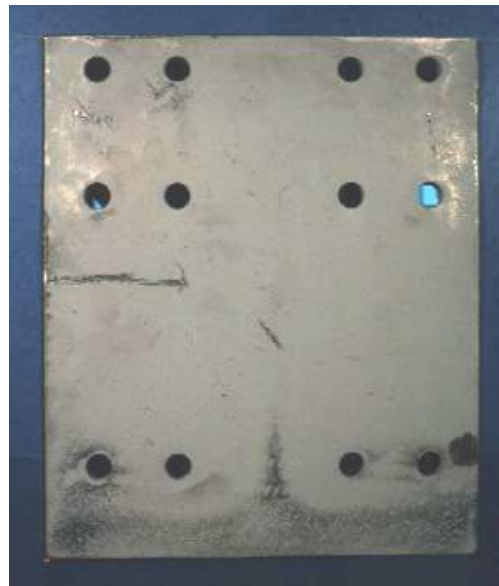
Abb. 6.09: Die Konzentrierung der Druckkraft im Bruchzustand an der Unterkante der Kopfplatte zeichnet sich durch entsprechendes Zermalmern und Abscheuern der Grundierfarbe auf der Verbindungsseite ab
