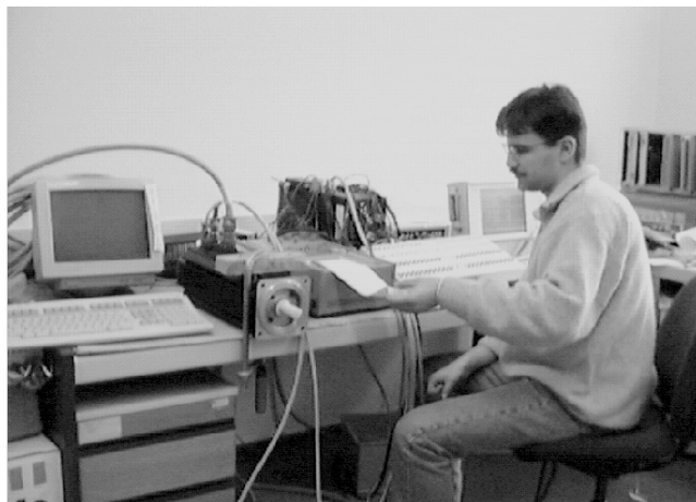
Bild (B131gekD) Experiment zur Bestimmung der Beschleunigung eines Roboterarmes
