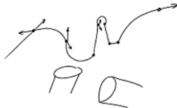
Bild (B048skiZ) Fehlerhafte oder schlechte Tangentialen
