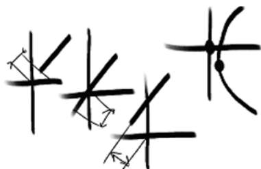
Bild (B040skiZ) Fehlerhafter oder schlechter Schnittpunkt
