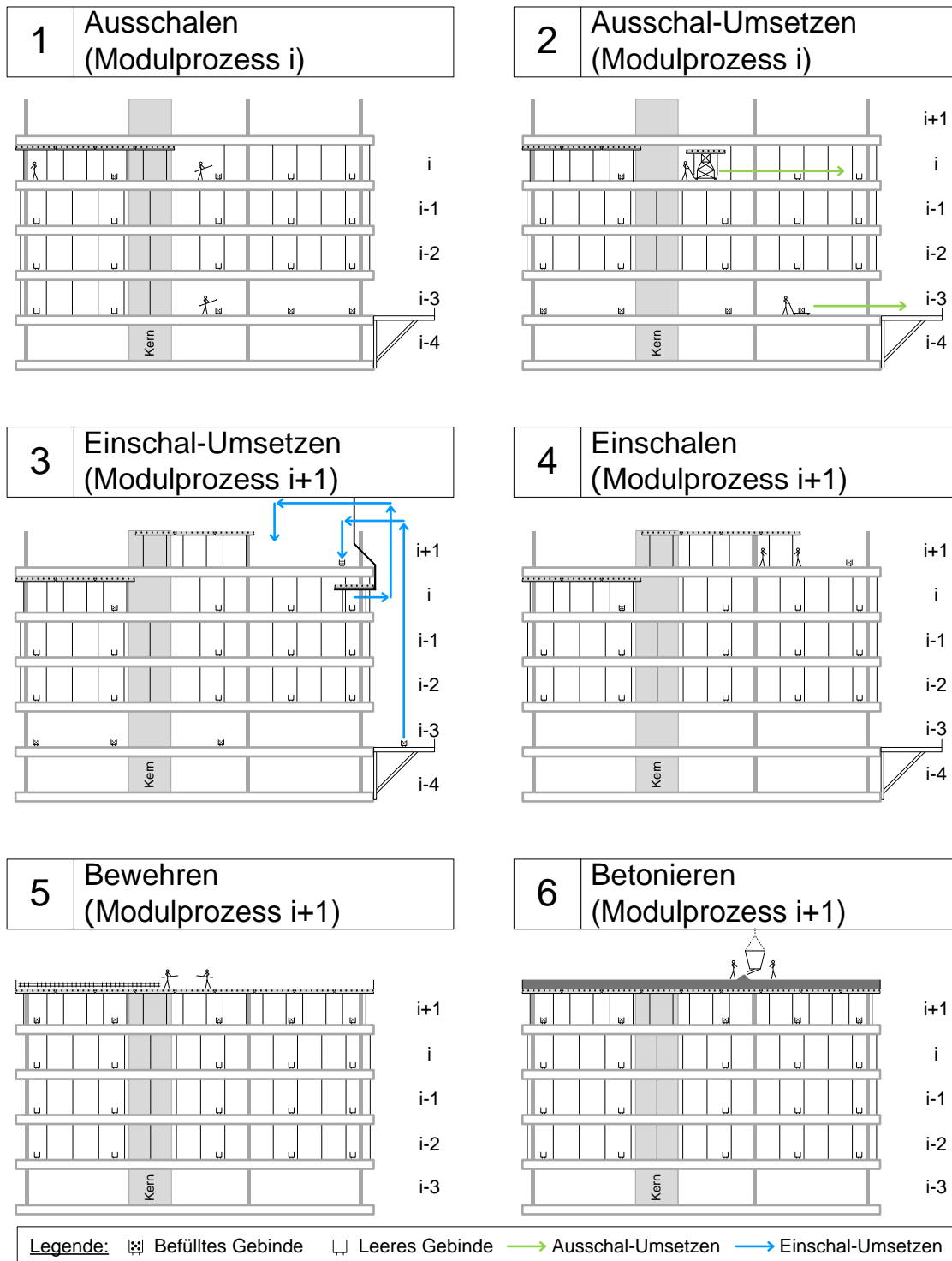
Bild 29: Herstellungsprozess Decke mit Deckentischen
