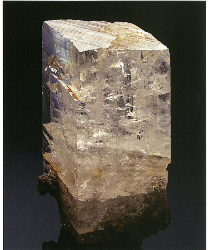
Rechter Karlsbader Zwilling. Die (001)-Spaltbarkeiten in der linken Hälfte zeigen auf den Betrachter, während sie auf der rechten Seite von ihm weg zeigen. Im unteren Bereich ist der Kristall nicht verzwillingt, was man am gleichen Orientierungssinn der Spaltbarkeiten links und rechts erkennt. Die s-förmige Linie auf der rauhen Kopffläche ist die Zwillings-Verwachsungs- fläche zwischen den beiden Individuen. Die milchige Linie von der Mitte des Kristalls zur Zwillingsnaht auf der Kopffläche ist der Faden. Höhe 2,6 cm. Sammlung M. Zorž.
