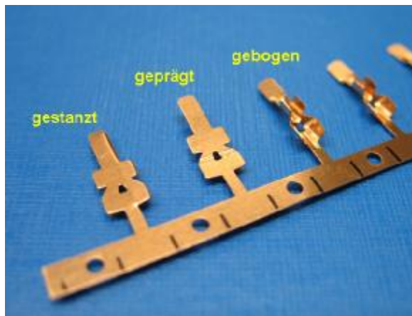
Bild 11: Stadienfolge beim modifizierten Biegeprozess und umgeformtes Bauteil ohne Riss
