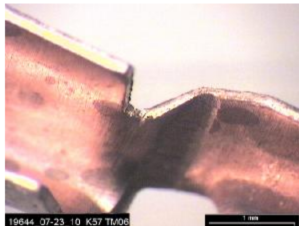
Bild 11: Stadienfolge beim modifizierten Biegeprozess und umgeformtes Bauteil ohne Riss
