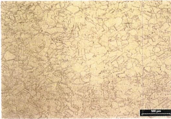
Bild 18. Geätzter Längsschliff durch ein weiches Band aus CuZn37. In den polygonalen Körnern liegen Rekristallisationszwillinge vor
