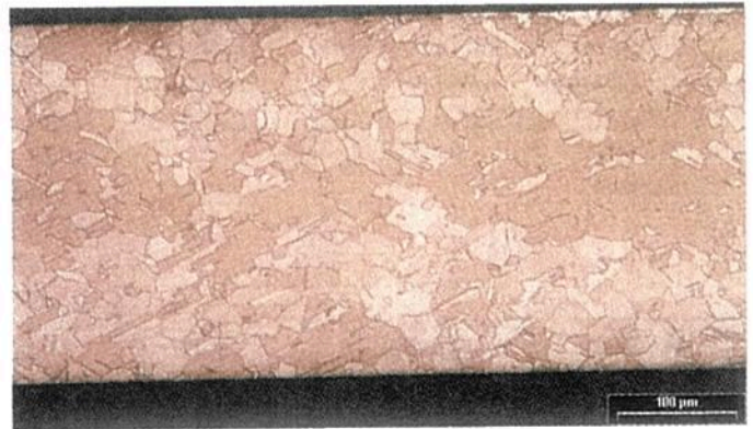
Bild 2. Stelle von Bild 1 nach einer zusätzlichen Ätzung in salzsaurer FeCl_3 -Lösung
