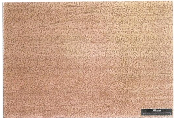
Bild 6. Überaltertes Gefüge eines Bandes aus CuFe 2 P mit Eisen- und Eisenphosphidausscheidungen; geätzter Längsschliff
