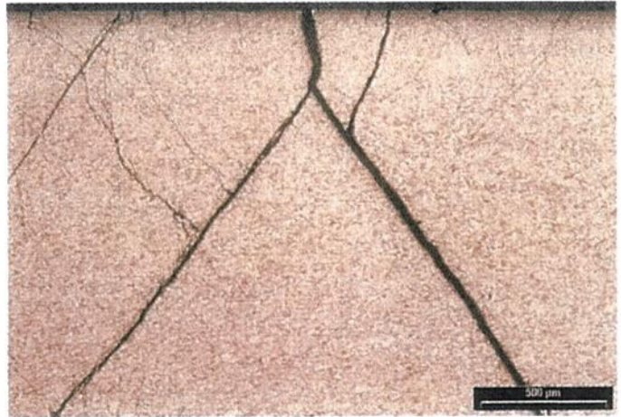
Bild 35. Spannungsrisskorrosion in einer gezogenen Rundstange aus CuZn36Pb2As nach einer 24-stündigen Lagerung über 12,5% NH 3 gemäß DIN ISO 50916 T1; geätzter Längsschliff
