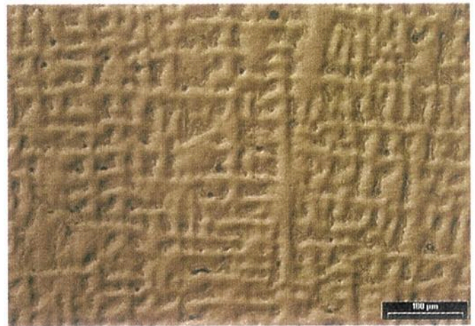
Bild 11. Kristallseigerungen im geätzten Gussgefüge der Legierung CuSn12-C. Die Aufnahme wurde in polarisiertem Licht durchgeführt.
