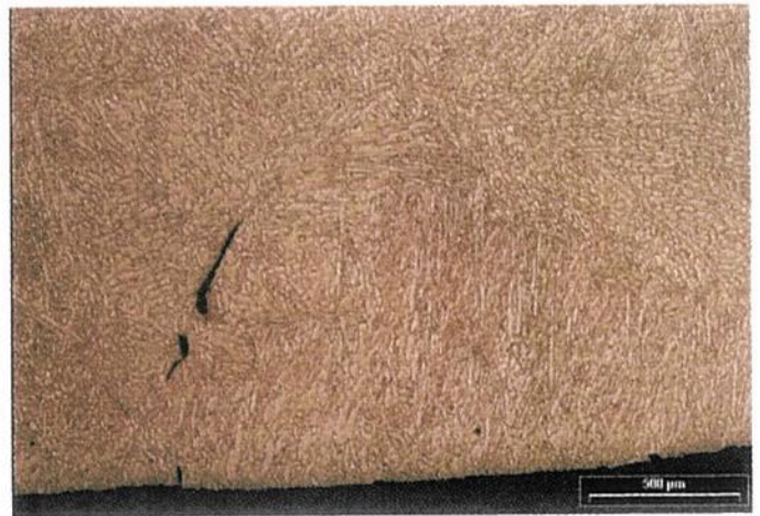
Bild 31. Detail aus Bild 30: interkristalline Risse entlang ehemaliger \beta -Korngrenzen
