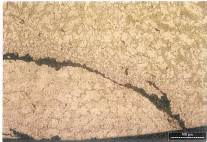
Bild 29. Geätzter Schliff durch eine schuppenartige Oberflächenbeschädigung auf einem Schmiedeteil aus CuZn40Pb2
