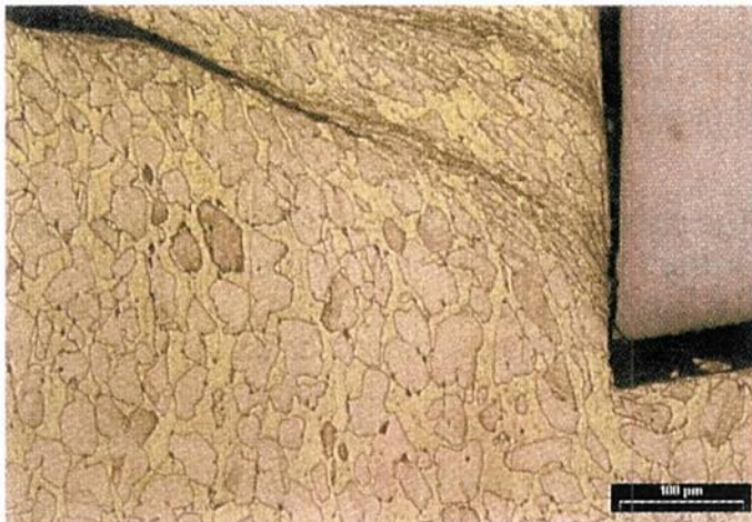
Bild 26. Geätzter Schliff durch eine Spanwurzel, die beim Bohren von CuZn40Pb2 entstanden ist
