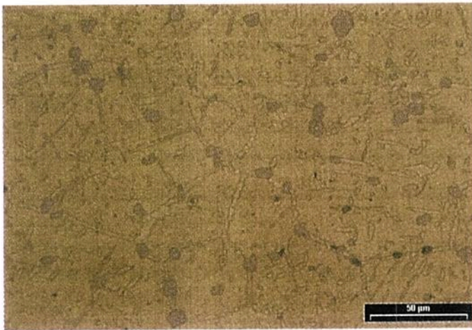
Bild 24. Ungeätzter Querschliff durch die stranggepresste und gezogene CuZn37Mn3Al2PbSi-Stange aus Bild 23
