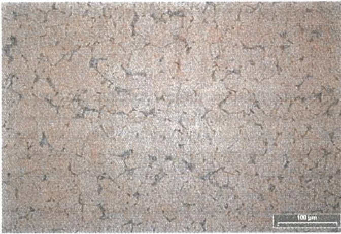
Bild 16. Geätztes sprühkompaktiertes Gussgefüge einer Zinnbronze mit der Zusammensetzung CuSn15,5
