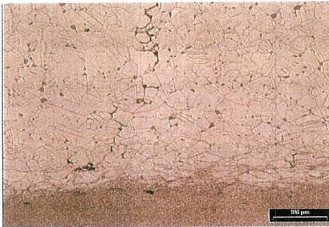
Bild 32. Geätzter Längsschliff durch die stark verschlissene Wandung eines Bohrlochs in einem Fitting aus CuZn36Pb2As. Von den deformierten Randbereichen unten gehen interkristalline Risse aus
