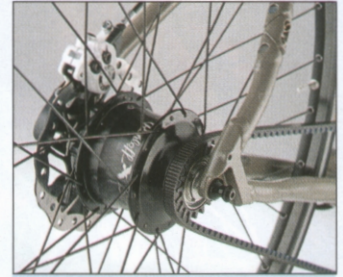
1 A: Scheibenbremse, Rohloff & Riemen
