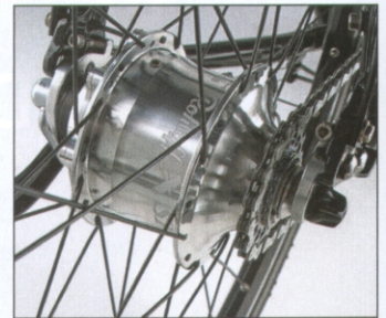
Top: die Rohloff-Getriebeabgabe ist extrem wartungsarm und funktionell!
