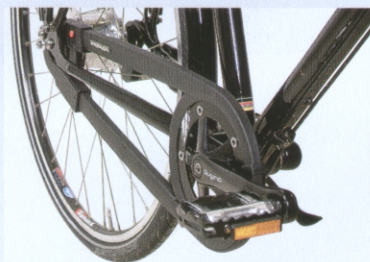
Wartungsarm: Der geschlossene Hebie-Chain-glider-Kettenkasten am Fahrradmanufaktur T-900 (auch Wanderer, Gudereit, Radon) sorgt für ein langes Kettenleben und schützt die Kleidung im Alltag.
