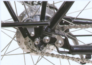
Bedienerfreundlich: Am neuen, sauber verarbeiteten Koga-Miyata KS-TR26-Rahmen lässt sich die Kettenspannung der Rohloff-Nabe per Inbus-schraube an den Ausfallenden fein justieren.
