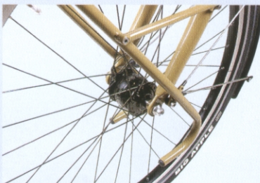
Schön gemacht: Farblich abgestimmter, pulverbeschichteter Tubus-Träger und ein kugelformiger SON 20R-Leichtlaufabendynamo passen gut zur velotraum-Optik und funktionieren auch entsprechend.
