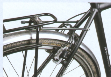
Intelligent: Bei Stevens sorgt ein Tubus-Gepäck-träger mit zweiter Packebene für einen tiefen Schwerpunkt (auch Wanderer, Koga, TrengaDE). Doppelte Brakebooster verbessern die Dosierbarkeit der HS-33.
