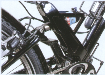
Komfortabel: Die aufwendige Dämpferaufnahme am Delite Traveller beherbergt einen Manitou-Luftdämpfer, dank dem der gut gelagerte Eingelenkerhinterbau sensibel anspricht.
