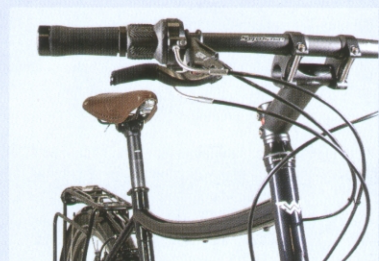
Ergonomisch: Bei Wanderer sorgen ein spezielles Rahmenkonzept, das gebogene Oberrohr, der vorgealterte Brooks-Ledersattel und das verstellbare Syntace-Cockpit (auch Radon) für viel Komfort.
