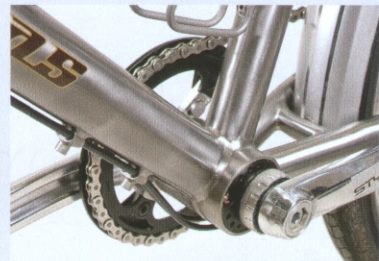
Sinn fürs Detail: Van Nicholas glänzt mit feinen Schweißnähten, Zugverlegung unter dem 3. Flaschenhalter und innen geklemmtem Exzenter-Tretlager (auch Wanderer, Stevens, Radon).
