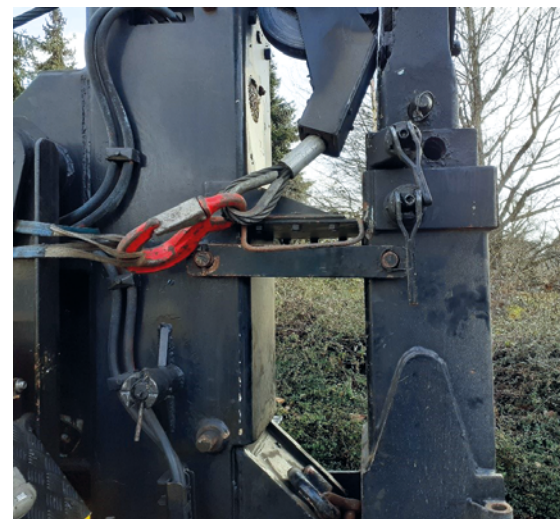
Abbildung 6: Metallschiene als Notsicherung der Abschleppvorrichtung
