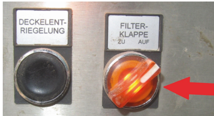
Abbildung 9: Bedienschalter für das manuelle Verfahren der Filterklappe
