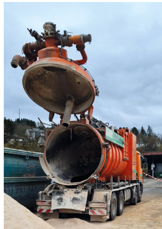
Abbildung 8: Rückansicht des Fahrzeuges mit geöffneter Trommelklappe
