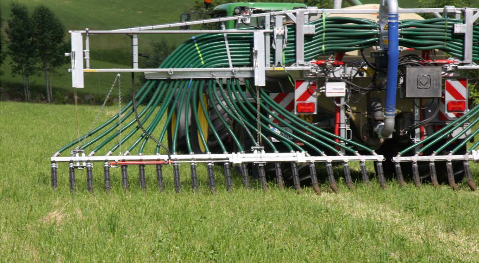
Bild 3: Die bodennahe Ausbringung mittels Schleppschuhtechnik erlaubt es, in Grünland- und Ackerfutterbeständen Gülle möglichst verlust- und verschmutzungsarm auszubringen. Foto: BWSB
