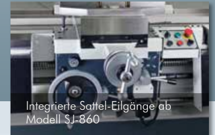
Induktionsgehärtete und präzisionsgeschliffene Führungen
