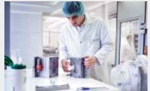
Die Spritzgusswerkzeuge werden bereits beim Zusammenbau vorgereinigt und desinfiziert
