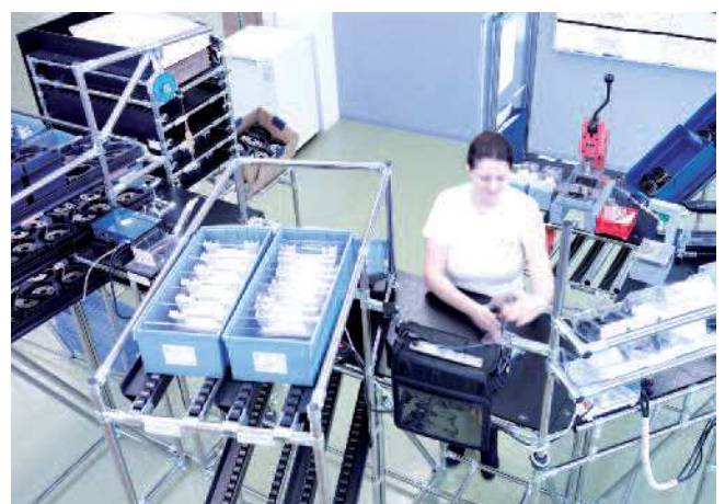
Bild 34: Montage im One-Piece Flow (LEAN)
