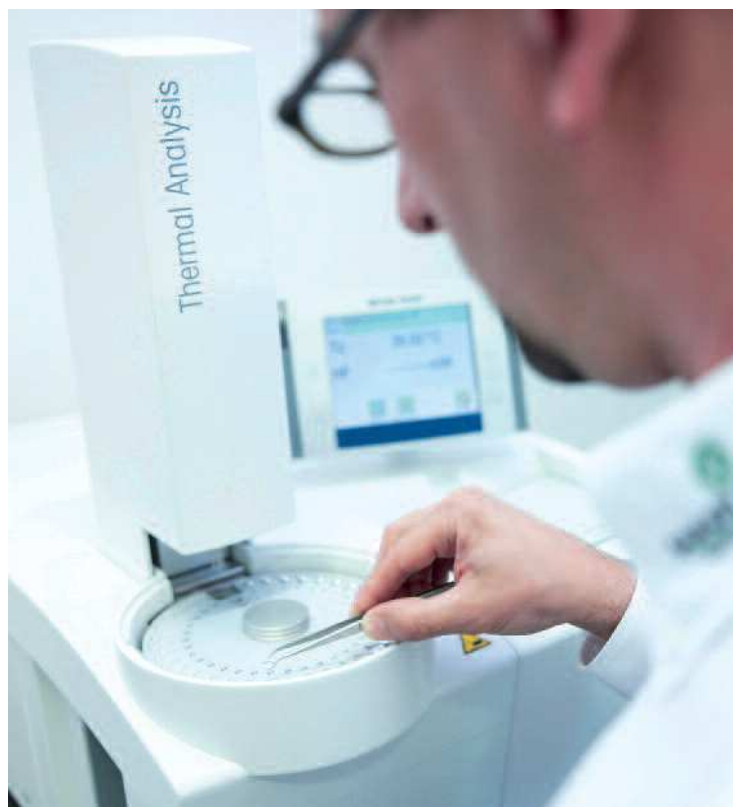
Bild 22: Technisches Labor (DSC)
