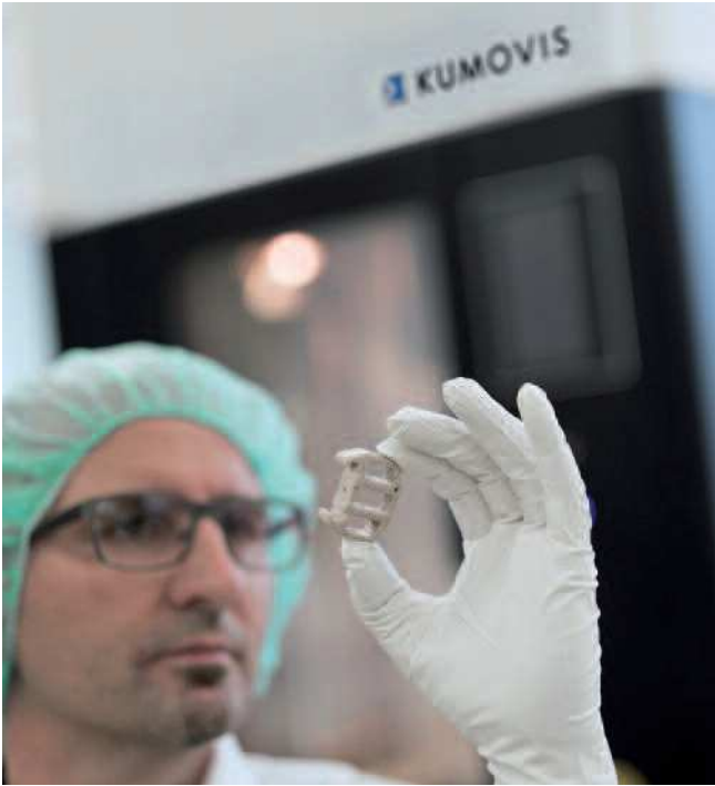
Bild 26: Peek Cages im AM-Verfahren hergestellt
