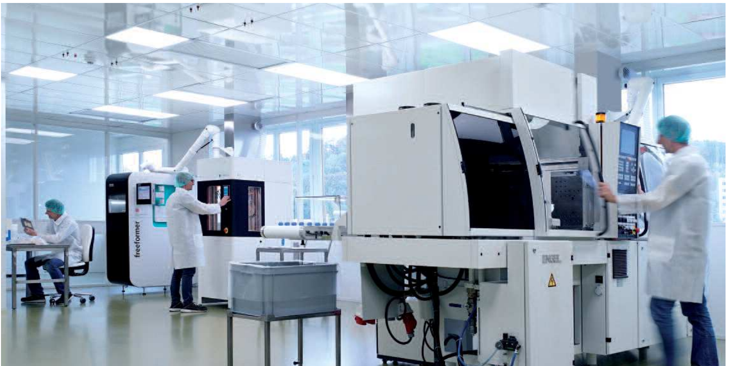
Bild 28: Reinraum (ISO 8) für Prototyping
