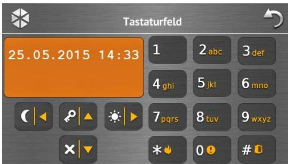
Das Tastaturfeld ermöglicht die Bedienung und Parametrierung des Alarmsystems genauso wie über ein LCD-Bedienteil mit dem Textmenü. In den Parametrierungs- und Benutzeranleitungen der Alarmzentrale wurde beschrieben, wie solch ein Bedienteil verwendet werden soll (diese Anleitungen sind in elektronischer Form unter [www.satel.eu](http://www.satel.eu) verfügbar).
