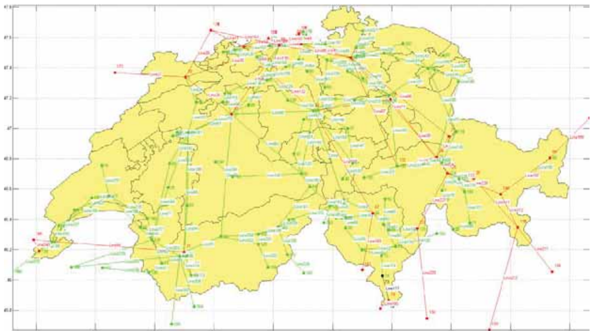
Abbildung 5 – Das Schweiz Stromnetz (basierend auf dem Netzmodell für das Jahr 2010, rot: 380 kV, grün: 220 kV, schwarz: 150kV -- Quelle: swissgrid)
