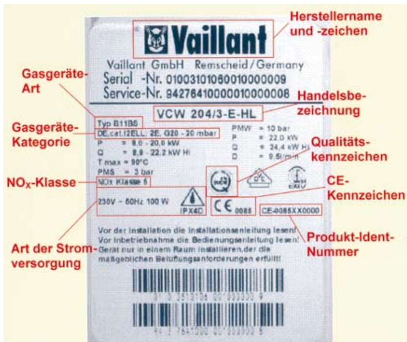
Das Typenschild eines Gasgerätes enthält alle notwendigen Informationen
