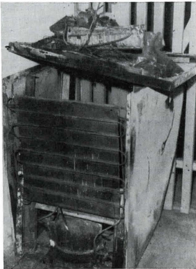
Bild 7. Reste eines verbrannten Kühl- schrankes.
