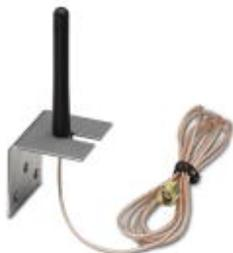
Rundstrahlantenne, 2,4 GHz, Gewinn: 2 dBi, Polarisation: linear, Öffnungswinkel: h/v 360°/75°, Schutzart: IP65, Anschluss: RSMA (male), inkl. 1,5-m-Anschlusskabel und Montagewinkel für Wandmontage
