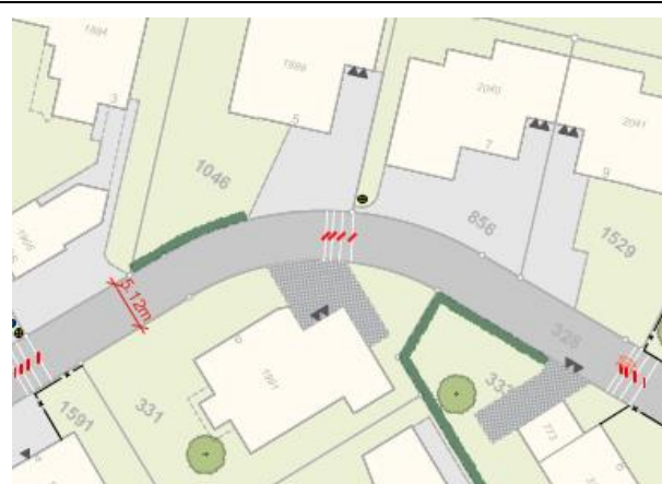
Abbildung 21: Aufhebung bestehende Markierung
