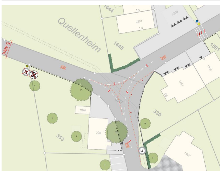
Abbildung 16: Knotengestaltung Knoten Forrenstr. / Rietstr. / "Urteilen"
