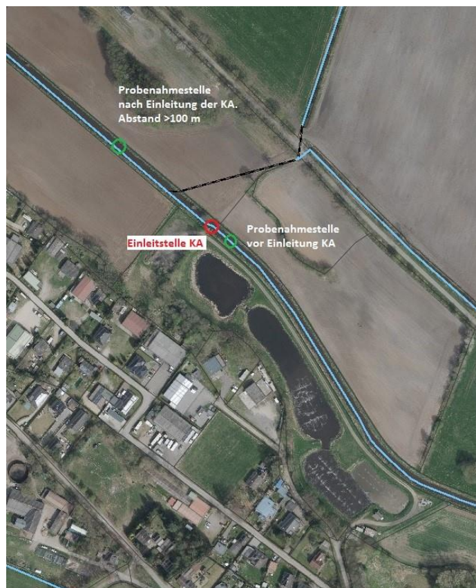
Abbildung 3-1 Beispiel für Messstellen, wenn die Einleitstelle der Kläranlage im reduzierten Gewässernetz liegt
