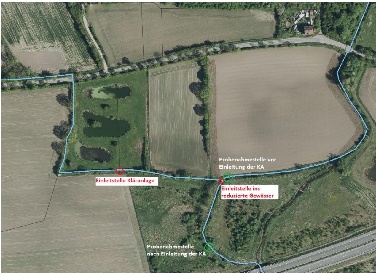
Abbildung 3-2 Beispiel für Messstellen, wenn die Einleitstelle der Kläranlage außerhalb des reduzierten Gewässernetzes liegt
