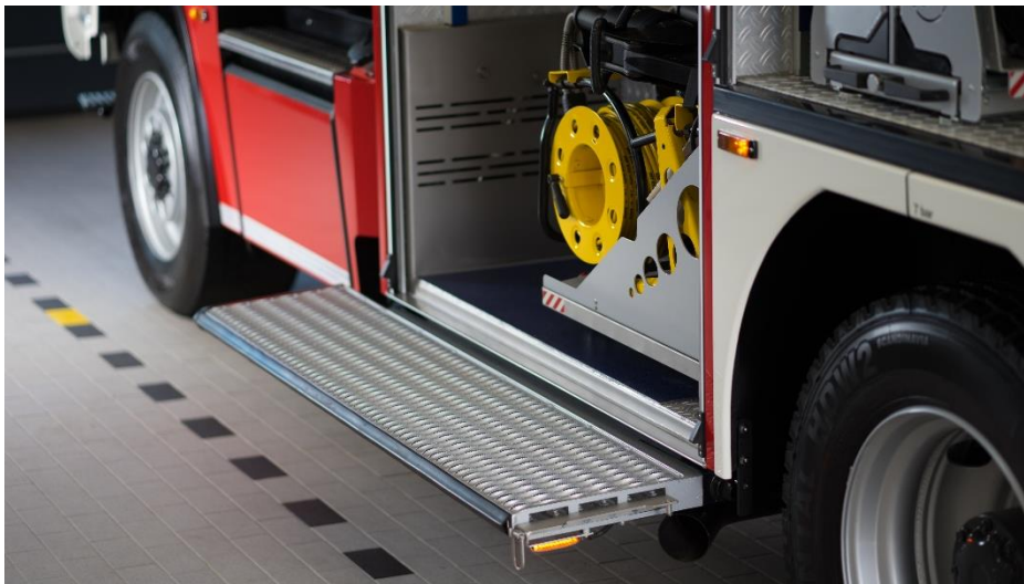
Schmutz kann durch den Gitterrost einfach hindurch fallen und gelangt somit nicht in den Geräteraum
