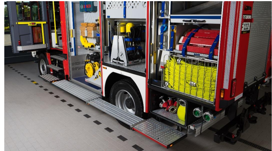
Durch das auf Wunsch lieferbare Sicherheits-Auftritt-System „SAS“ lässt sich der pneumatische Tritt zu einer durchgängigen Tritfläche über die gesamte Länge des Gerätekooffers erweitern.
