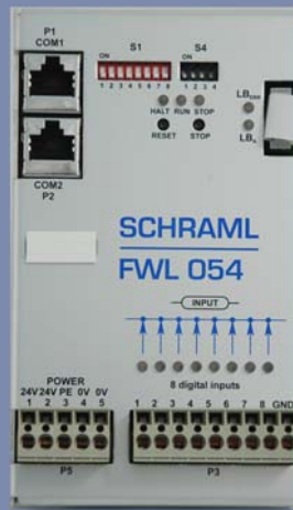
Störmelder FWL 054 mit 8 DE on board (modular erweiterbar)
