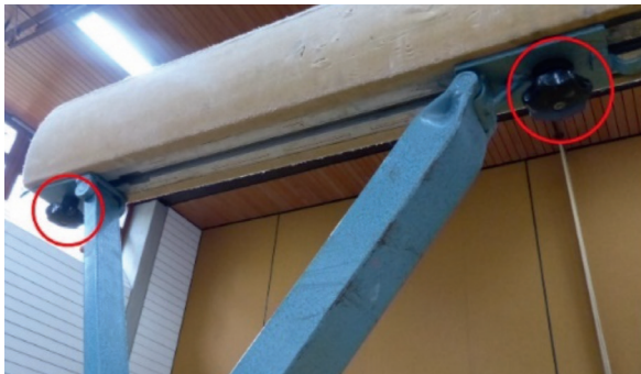
Abb. 44: Stellschrauben am Schwebebalken
