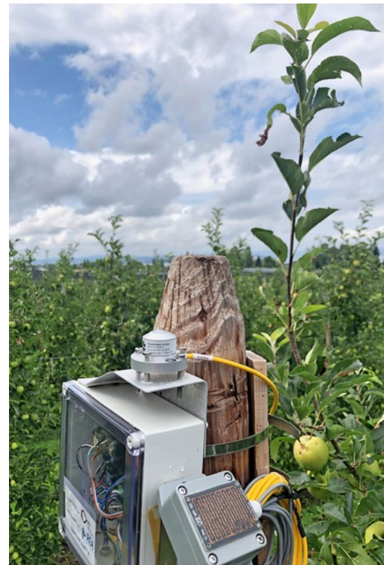
Messstation in einer Thurgauer Obstplantage: Dank dem Projekt «Smart Water» lässt sich berechnen, wie viel Wasser die Pflanzen mindestens benötigen, um nicht zu welken. Bild: zvg/Fachhochschule OST
