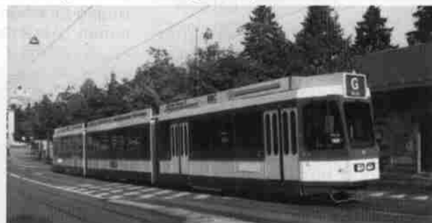
Zweirichtungs-Gelenkwagen; Länge 31,2 m
