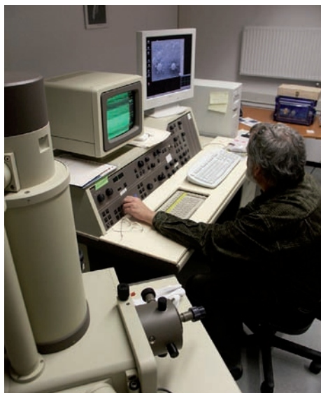
Herbert Boyle am museumseigenen Rasterelektronenmikroskop. Mithilfe des 1996 erworbenen Geräts können feinste Oberflächenstrukturen sichtbar gemacht werden.
